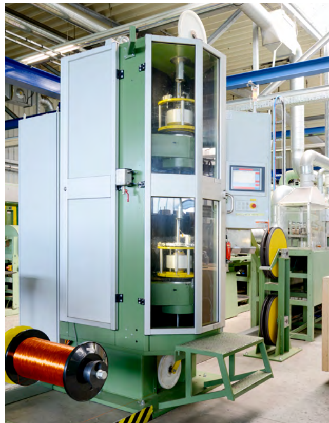
Glasseiden- u. Mischgarn-Isolieranlage
